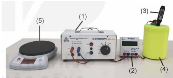
Hình 4.1. Bộ thí nghiệm thực hành đo nhiệt dung riêng của nước
