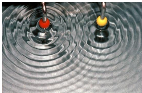
Thí nghiệm tạo ra sự giao thoa của hai sóng nước
