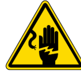
Nguồn điện nguy hiểm
